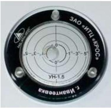
*Указатель угла наклона УН-1.5*
