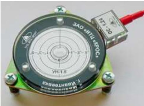
*Указатель угла наклона УН-1.5КП*
