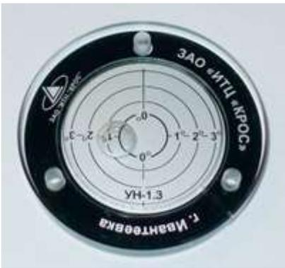
*Указатель угла наклона УН-1.3*
