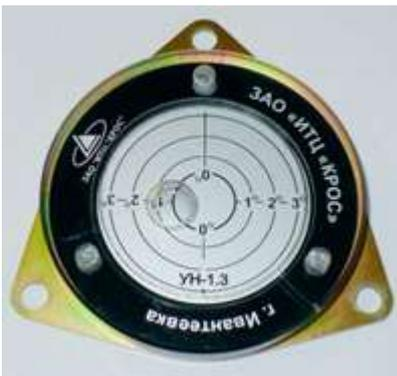
*Указатель угла наклона УН-1.3К*
