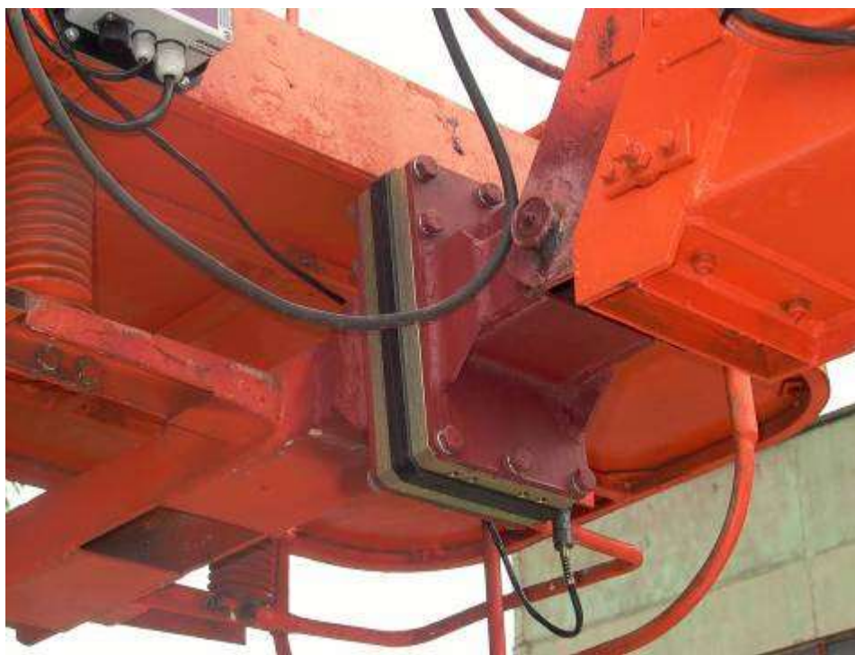
Установка модуля «МДН» на подъемнике
