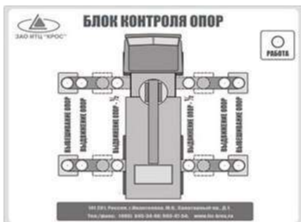
Панель индикации блока контроля опор БКО
