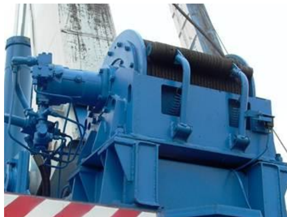
Пример установки лебедки ЛГ-55 на стреловом кране
